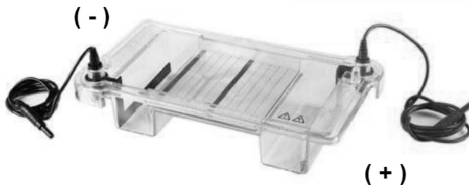
**Figura 2: Cuba de Eletroforese horizontal.** O gel é colocado em uma cuba com solução salina e uma corrente elétrica é aplicada. O DNA migra para o polo positivo.
